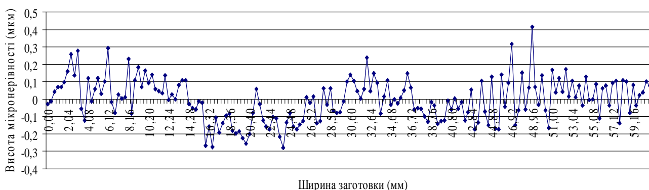
Рис. 6. Результати імітаційного моделювання утворення шорсткості оброблення плоскої поверхні зі сталі 40 (ділянка 0 – 60 мм) комбінованою торцевою фрезою ( V = 190 м/хв; S = 0,15 мм/об; t = 0,1 мм; P = 1000 Н)
